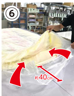
⑥ 上部の40cm余ったチューブ袋を③で折り返した部分の内側に入れ混みます
