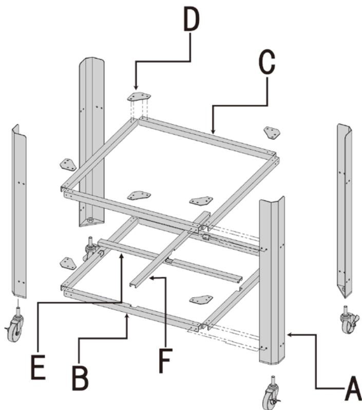
※付属のネジを使用して、【A】～【D】の部品を全て取り付けるまで、ネジを最後まで締めきらないようにしてください。途中でネジが入らなくなる場所が出ることがあります。
